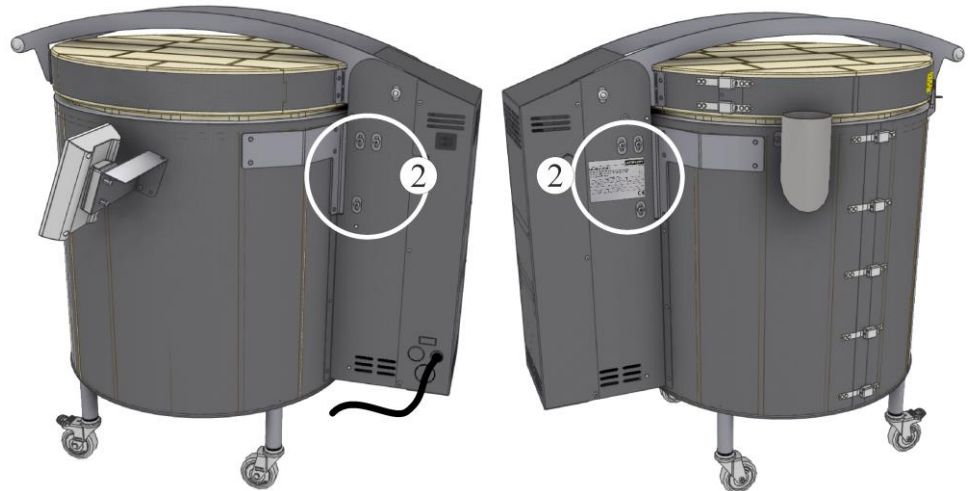
45 ábra: Csavarok a fedél beállításához (az ábrán láthatóhoz hasonlóan)
