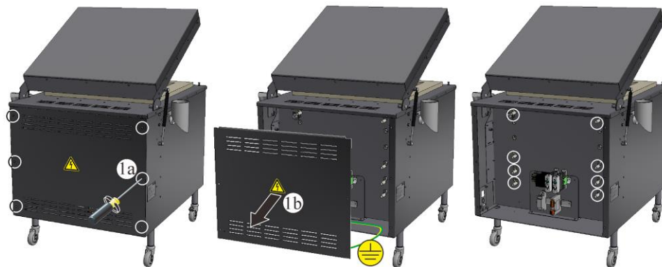
75 ábra: A kapcsolóberendezés burkolatának leszerelése a kemence hátljáról (az ábrán láthatóhoz hasonlóan)
