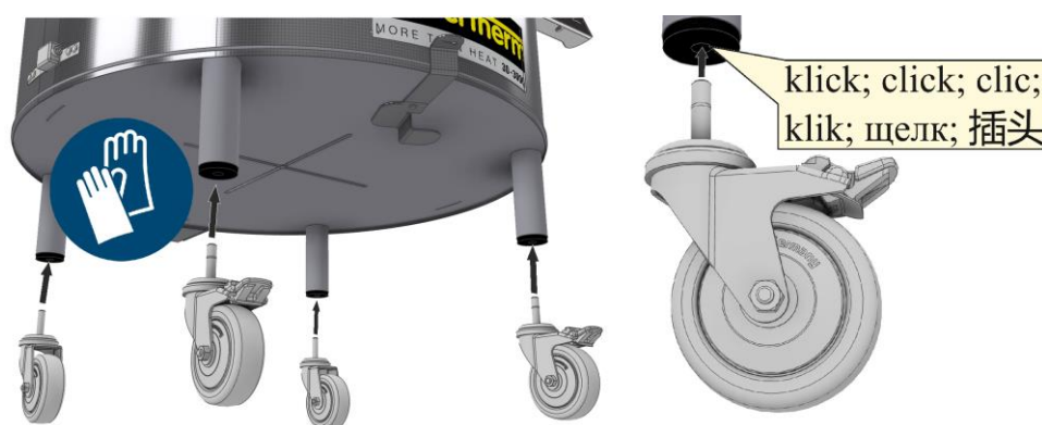
15 ábra: A szállítógörgők szerelése (az ábrán láthatóhoz hasonlóan)
